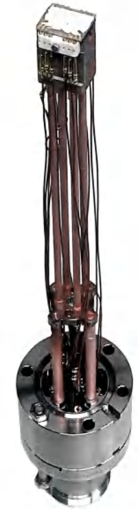
Abb. 4.6: Mikrofallensubstrat mit Halterung und elektrischen Kontakten
