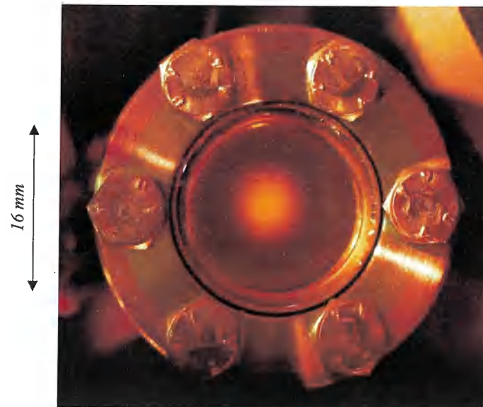
Abbildung 8.6: Blick durch eines der CF-16-Fenster auf die Wolke von etwa 2,5 \times 10^{10} fluoreszierenden Rubidiumatomen.
