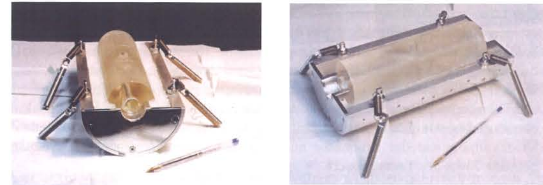
Abbildung 3.12: Fotos der Lagerung des Zerodur bzw. des alten ULE-Resonators in einer mit Glaskugeln gefüllten Wiege, die wiederum mit insgesamt acht Spiralfedern im Vakuumtank aufgehängt ist.
