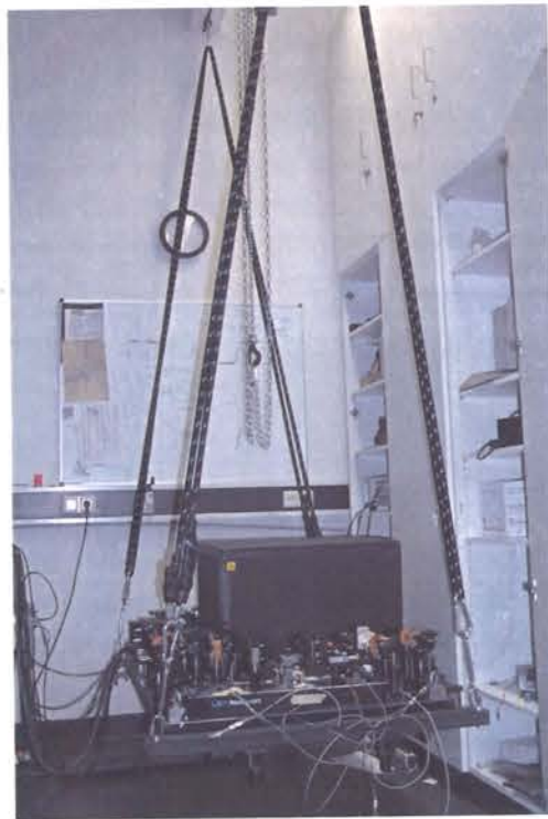
Abbildung 3.14: Foto des mit Gummi-Seilen an der Labordecke aufgehängten Breadboards mit dem gesamten Aufbau.
