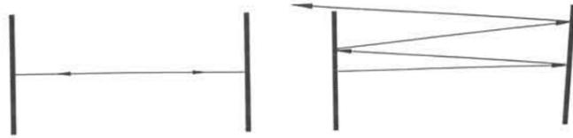
Abbildung 3.17: Resonator mit ebenen Spiegelflächen. Ein Lichtstrahl auf der optischen Achse bleibt im Resonator, falls die Spiegel perfekt parallel sind. Bei leichter Verkippung eines der beiden Spiegel verlässt er den Resonator.
