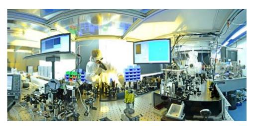
**Bildbeschreibung:** Blick ins Elektronendiffraktometrie-Labor. Hier wird mit Blitzen aus Elektronen der Mikrokosmos erforscht. Eine neue Stoppuhr hilft jetzt die ultrakurzen Blitze im Femtosekunden zeitlich exakt zu messen. Sie hat auch das Potenzial, in Attosekunden-dimensionen vorzustoßen. (**Foto: Thorsten Naeser**)
