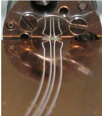
**Abb. 1:** Leiterelektroden mit Elektronenquelle im Hintergrund; die weißen Linien dazwischen sind das darunterliegende Substrat. Die Elektronen werden durch ein winziges Loch im Zentrum der Quelle, welches einen Durchmesser von  $20\mu\text{m}$  hat und auf dem Bild nicht zu erkennen ist, emittiert. Sie werden anschließend in einer Höhe von einem halben Millimeter über den Elektroden geführt und entlang der gebogenen Elektrodenstruktur im Vordergrund nach links abgelenkt.
