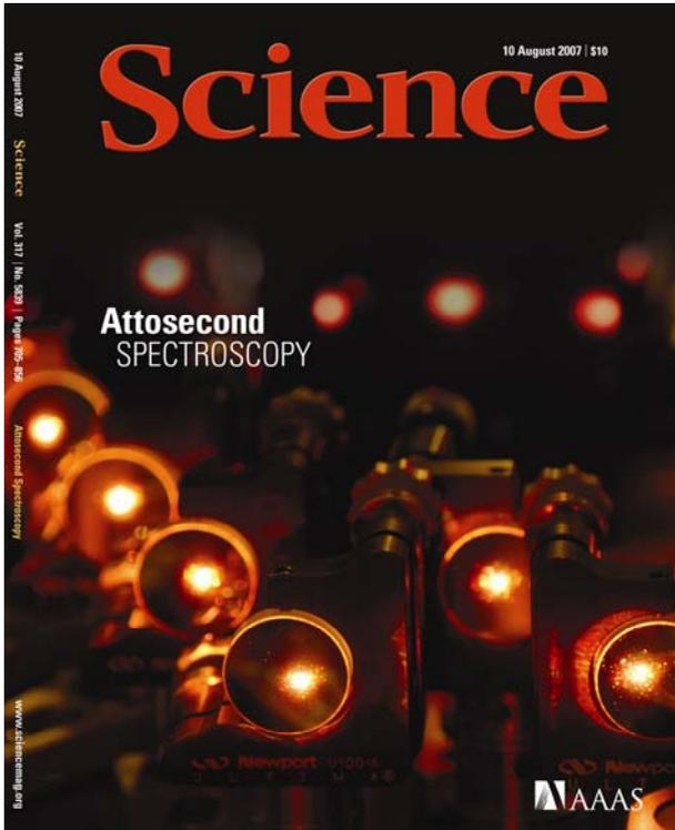
Eine Anordnung von Vielschichtspiegeln komprimiert Breitband-Laserpulse (orangefarbener Strahl) auf 1,5 Schwingungszyklen. Die dadurch erzeugten Attosekunden-Röntgenpulse ermöglichen die Steuerung und die Echtzeit-Beobachtung der Elektronenbewegung auf atomarer Skala. (S. Berichte zur Attosekunden-Spektroskopie ab S. 756)
