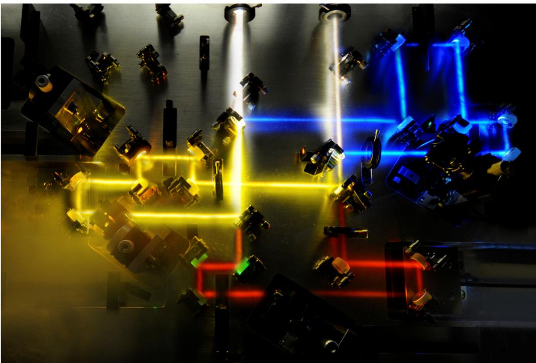
**Abb.:** Ein Lichtwellensynthetisator spaltet einfallendes weißes Laserlicht in drei Farbkanäle auf und modifiziert es anschließend. Das Zusammensetzen erzeugt Laserpulse mit komplexen, aber fein justierbaren Wellenverläufen. © **Thorsten Naeser**
